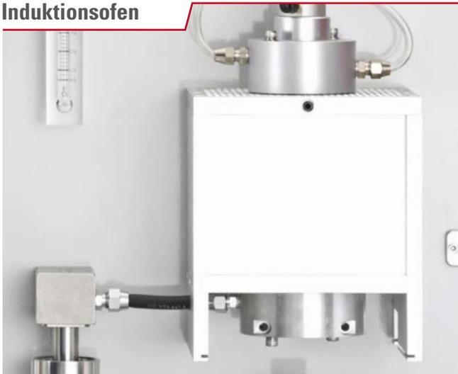
Der Ofen erhitzt die Probe durch Induktivität auf bis zu 2200 °C. Die Leistung dieses Prozesses wird durch den Computer kontrolliert und kann bis zu 2,2 kVA reichen.
