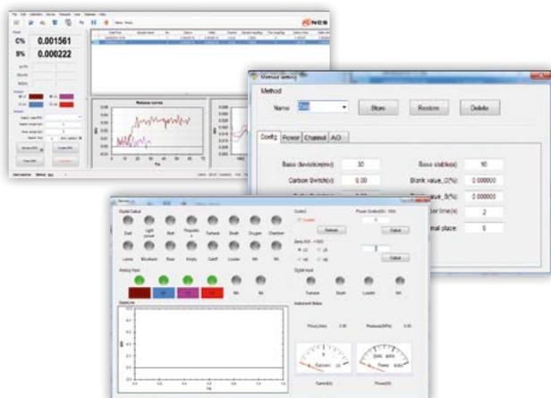
Die NCS Bediensoftware ermöglicht einen leichten Umgang mit dem Analysegerät. Sie vereint die Arbeitsoberfläche für die Probenanalyse und den Datentransfer mit den Einstellungen verschiedener Analysemethoden und Benutzerprofile.
